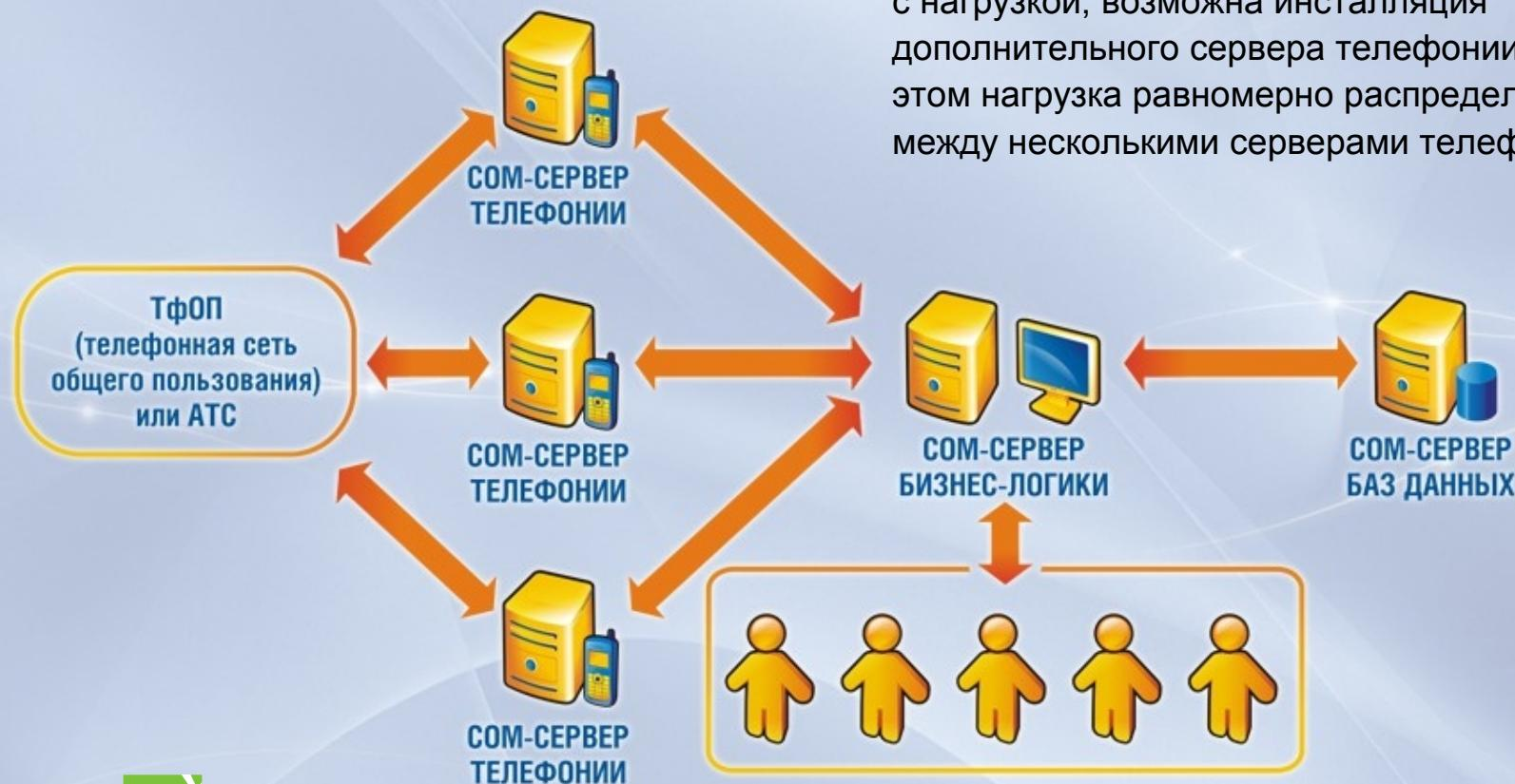
Если один сервер телефонии не справляется с нагрузкой, возможна инсталляция дополнительного сервера телефонии. При этом нагрузка равномерно распределяется между несколькими серверами телефонии.
